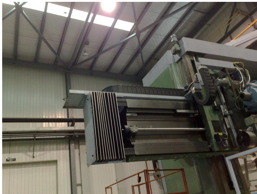
某公司大型龙门铣 Y轴用全封闭拖链ZF8080.200.250.BK Z轴用全封闭拖链 ZF8080.150.200.BK
