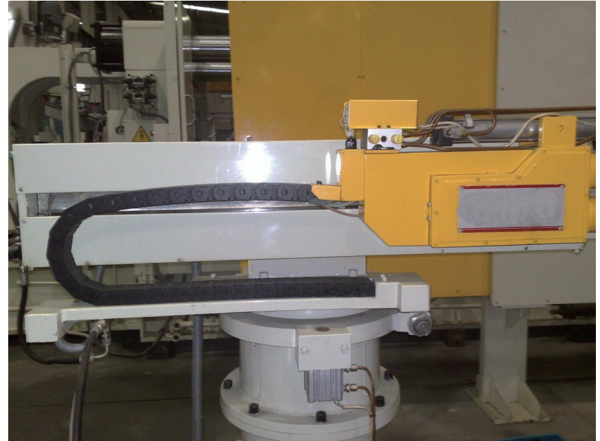
ZFG2580系列 压铸机用全封闭拖链 拖链型号: ZFG2580.075.150.BK
