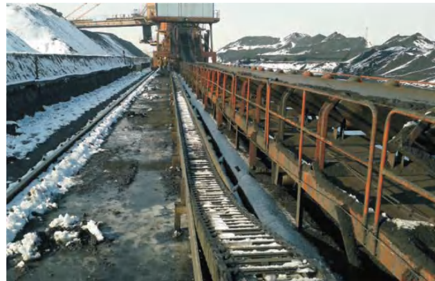
某电厂斗轮机 低温用长行程拖链 速度: V_{max}=40m/min 行程: S=200m 拖链型号: ZF8000系列
