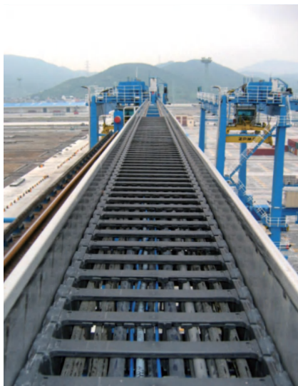
用于港口机械316号不锈钢材质，加强型导向槽（抗台风）
