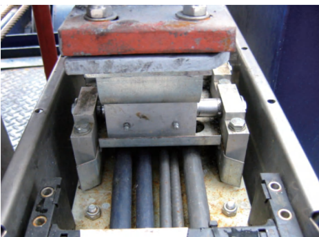
拖链行程较长时，为了防止小车运行中产生的偏移影响拖链运行，需要增加浮动头装置以纠正小车走偏对拖链带来的影响
