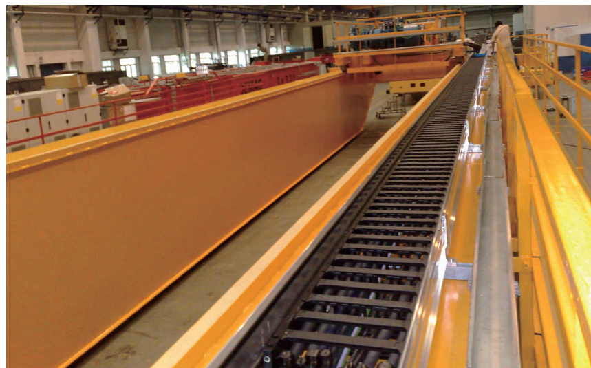
拖链型号: YFM5600.200.250.BK 造纸厂用多功能起重机
