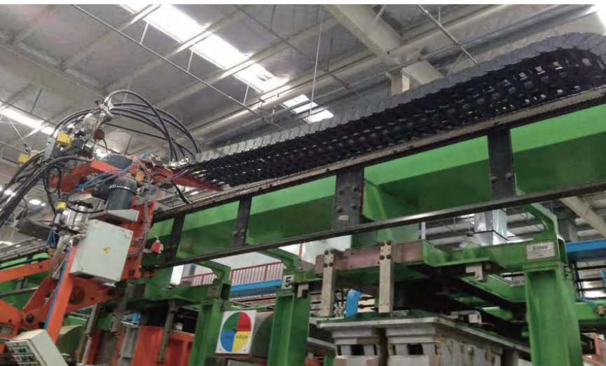
某家电生产线用拖链系统 行程S=20米 拖链型号ZF8000系列 Vmax=80m/min
