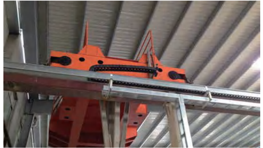
YFM3500. 075. 150. BK及附属电缆夹导向槽配件 用于建材输送小车
