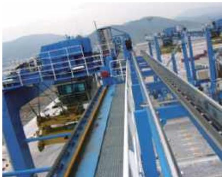
导向槽带耐磨滑条部分，耐磨滑条采用高密度耐磨高分子材料，摩擦系数低，对拖链磨损小
