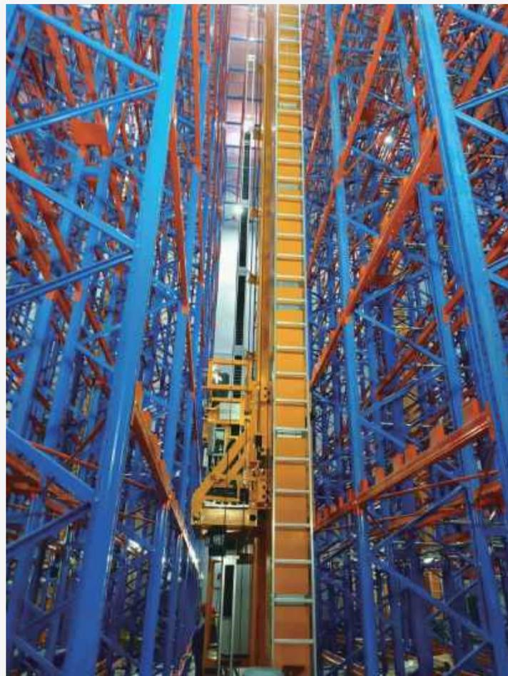
随着自动化立体仓库堆垛机移动速度越来越快，垂直升降用拖链在堆垛机移动供电中应用越来越频繁。立体仓库越来越大，堆垛机上下，前后行走距离也越来越大，拖链在快速长行程移动中，需要用垂直导向槽来导向，防止堆垛机快速移动时，拖链与周围货架有干涉，引发电气故障，影响立体库连续作业。
