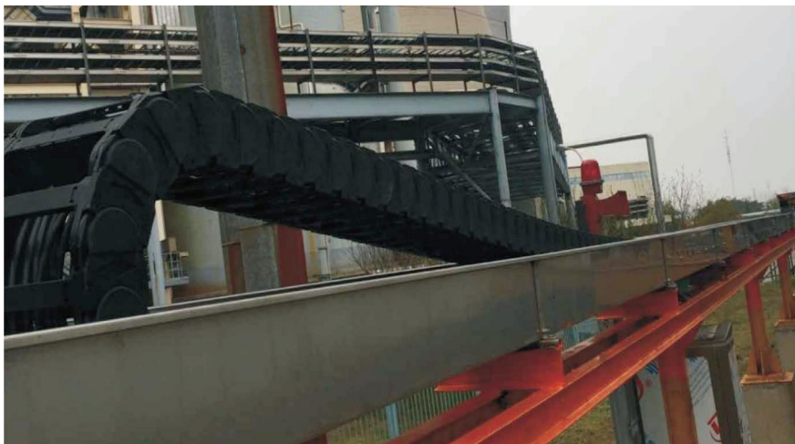
电厂翻车机 行程S=50米 拖链型号ZF8000系列 Vmax=80m/min
