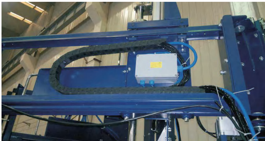
ZF1800系列 用于自动化电子设备 拖链型号：ZFG1800.025.075.BK
