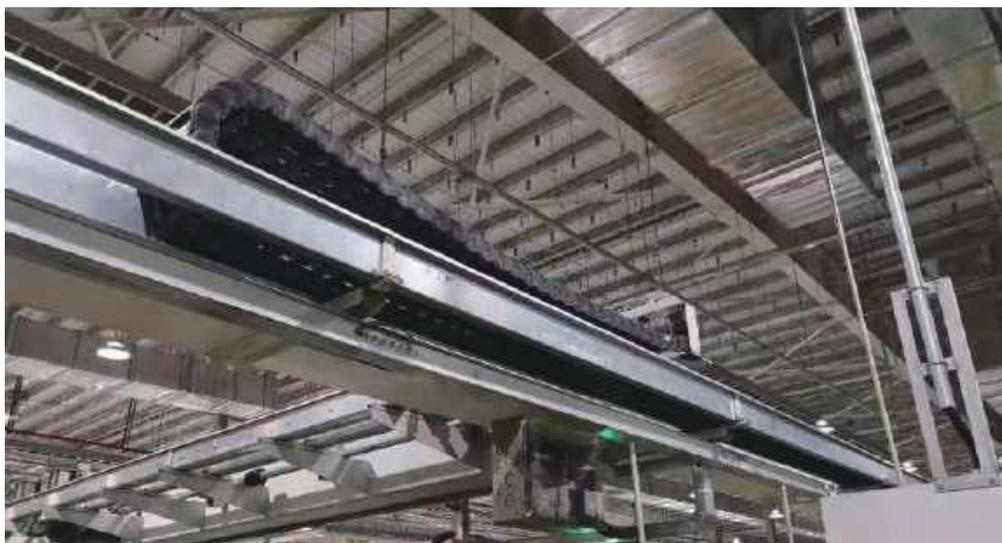
导向槽系统是长行程拖链运行时必不可少的导向装置。针对不同的应用，我们提供了多种不同的模块化导向槽，以确保拖链系统运行的高稳定性和长寿命。
