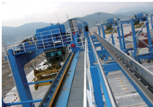
导向槽带耐磨滑条部分，耐磨滑条采用高密度耐磨高分子材料，摩擦系数低，对拖链条磨损小
