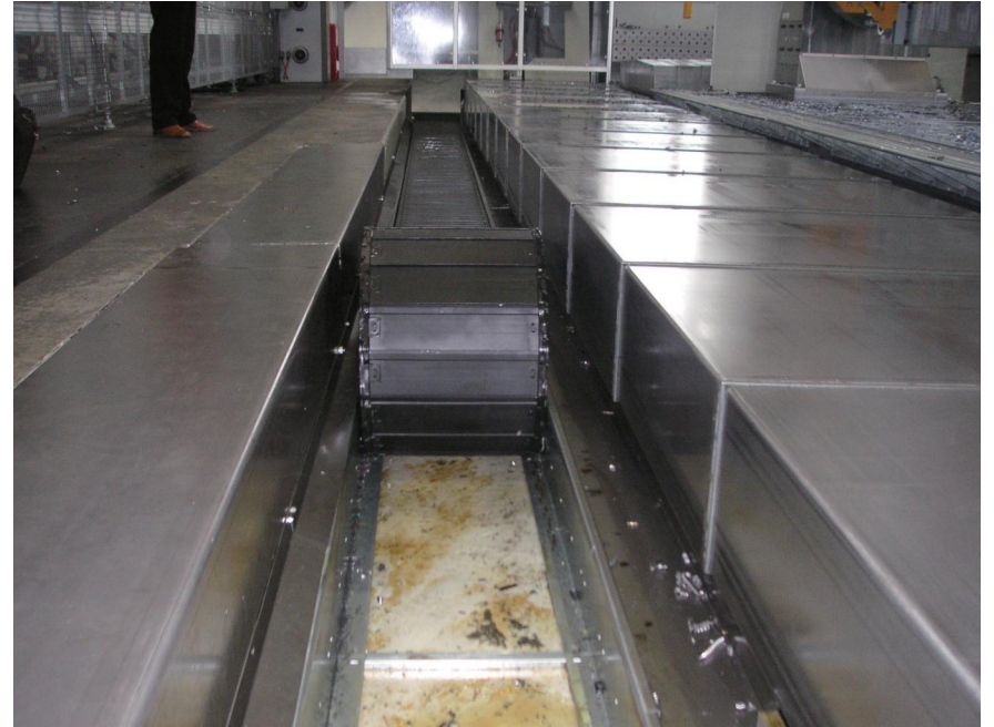
某公司大型落地镗机床, X轴 拖链型号: ZF8080. 250. 300. BK
