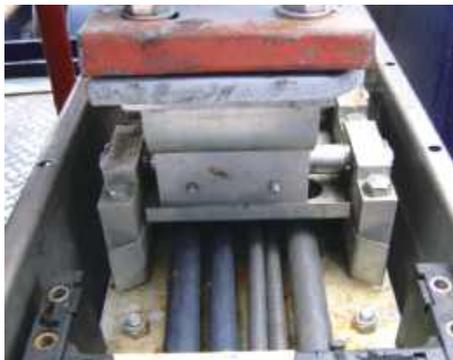
拖链行程较长时，为了防止小车运行中产生的偏移影响拖链运行，需要增加浮动头装置以纠正小车走偏对拖链带来的影响
