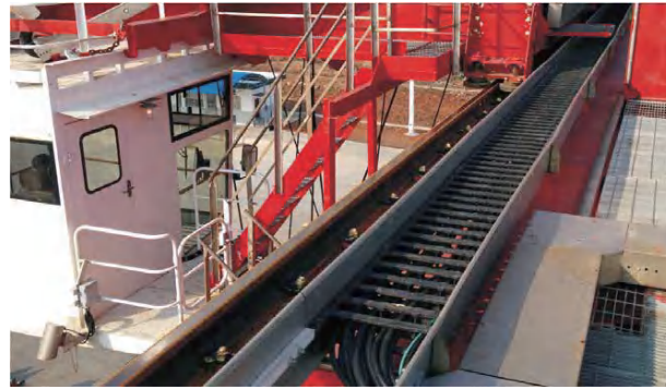
某铁路轨道吊 速度: V_{max}=120m/min 行程: S=40m 拖链型号: ZF8000系列
