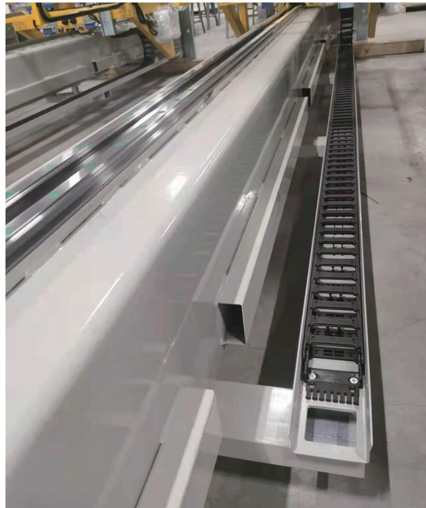
拖链型号: ZF2500.057.075.BK用于钣金生产线
