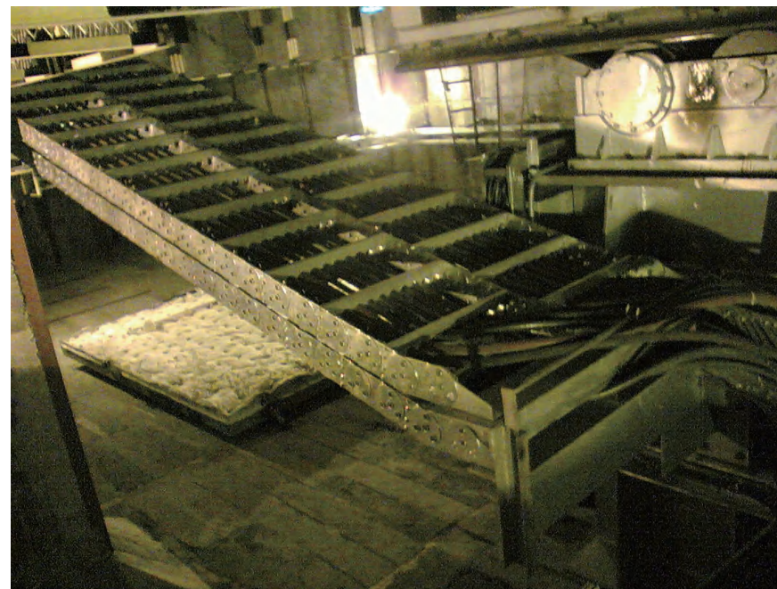
ZF-TL180系列 镀锌生产线感应炉上用钢制拖链
