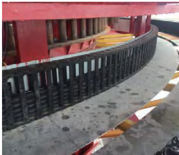
某电厂堆取料机回转装置用双向弯曲拖链系统（含导向槽） 拖链型号：ZF8000.300.300/2800.BK
