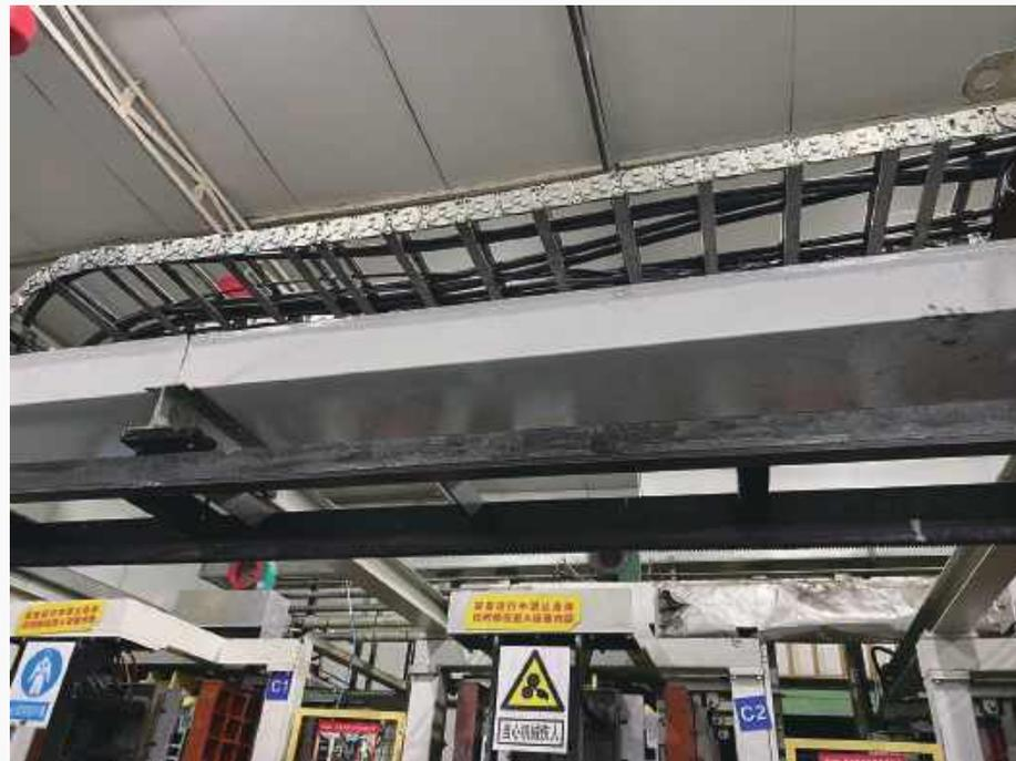
TL125敞开式钢拖链在冰箱发泡线的使用
