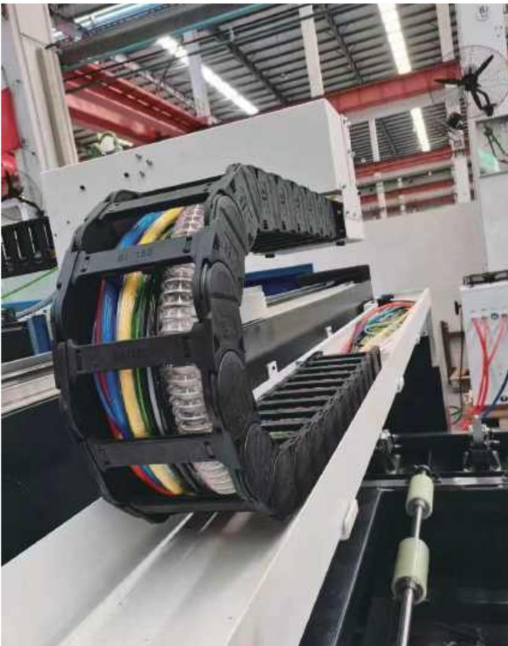
YFM4200.150.200.BK及其它拖链配件用于激光切割机某轴的横移应用场合
